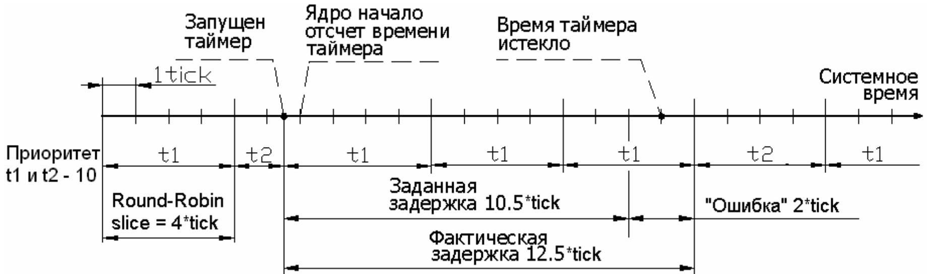
Рис. 1.7. Зависимость времени блокирования потока таймером от приоритета потока ( $t_2 = t_1$ )
