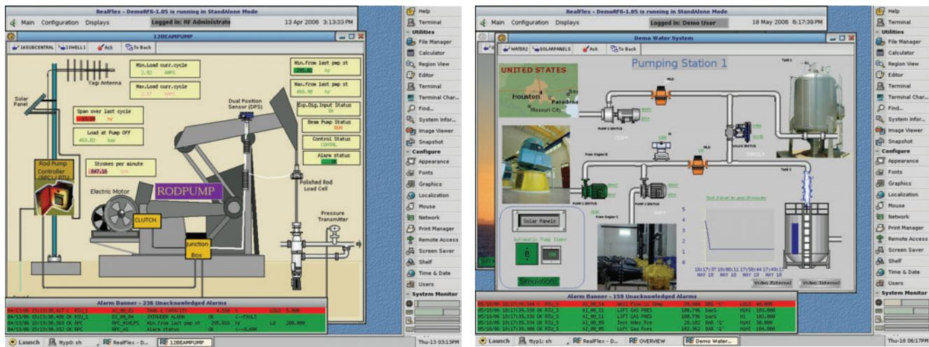
Для RealFlex 6 разработан графический интерфейс для работы под QNX Photon. Интерфейс может быть установлен на основную или резервную SCADA-систему на основе OCPB QNX 6.
