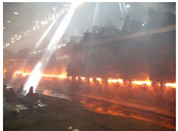
Рис. 5 Стан печной сварки труб ЧТПЗ
