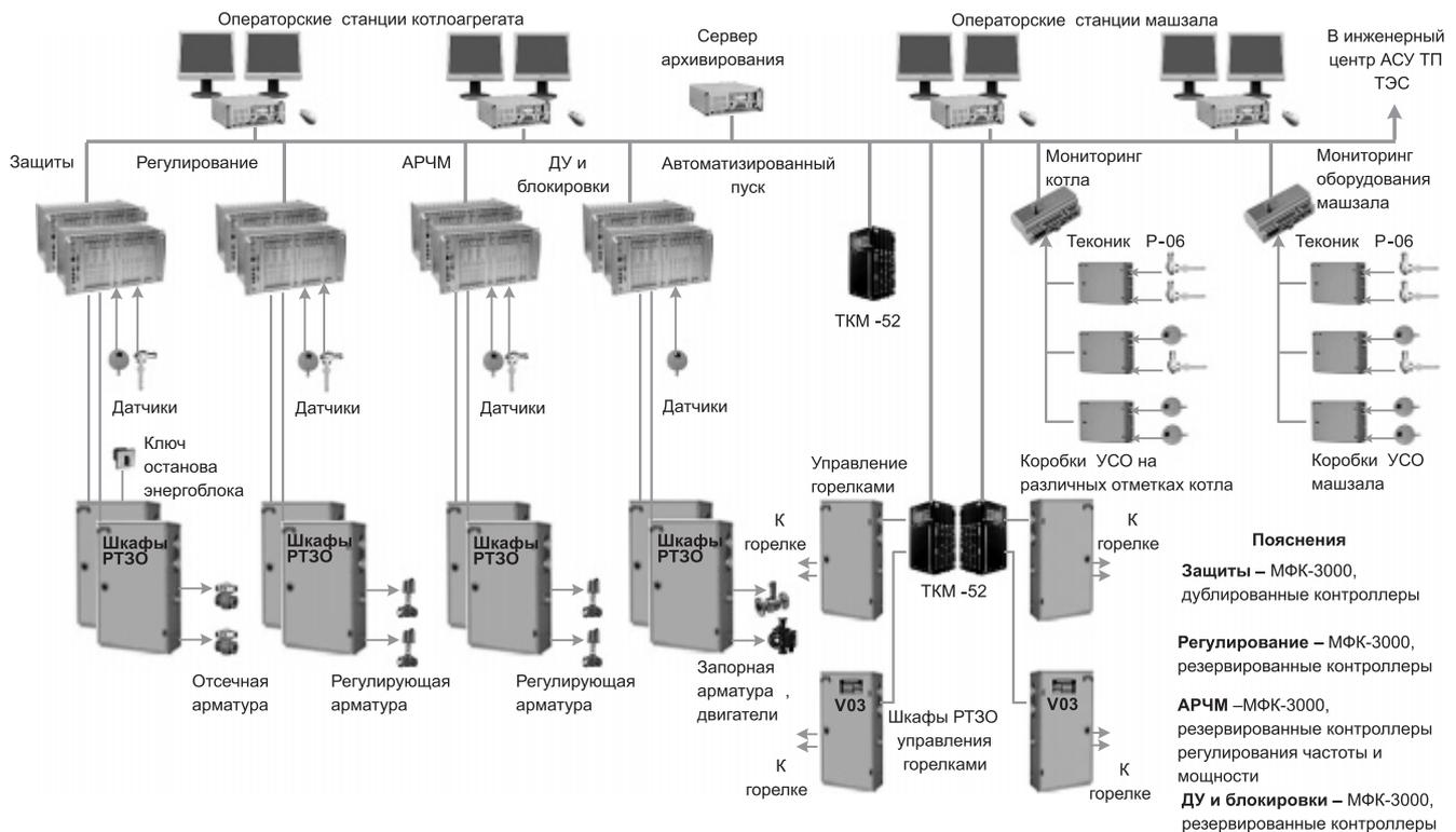
для трех паровых котлов; разработан проект, и на 2009 г. намечен ввод в эксплуатацию аналогичной системы для двух генераторов ГТУ мощностью по 150 МВт.
