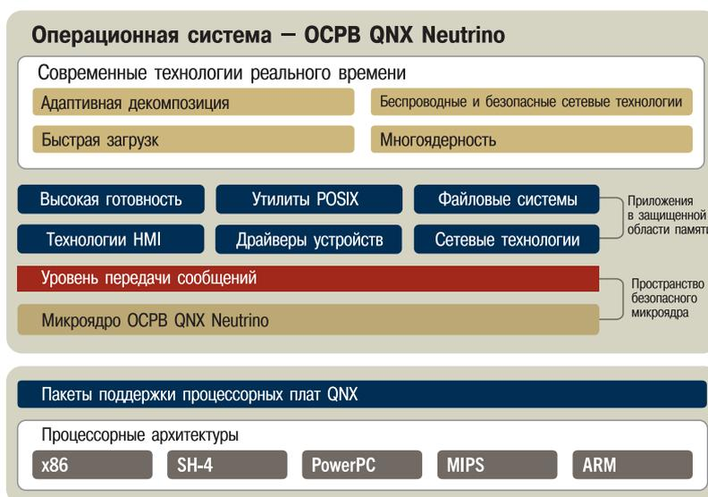
**Микроядерная архитектура QNX Neutrino с защитой памяти формирует надежную основу для систем, поддерживающих функции самовосстановления, динамическое обновление и большие возможности по масштабированию.**
